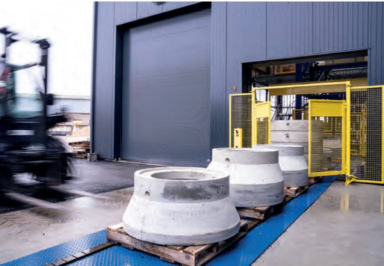
После распалубки элементы колодцев покидают здание полностью готовыми к погрузке на транспортные паллеты
