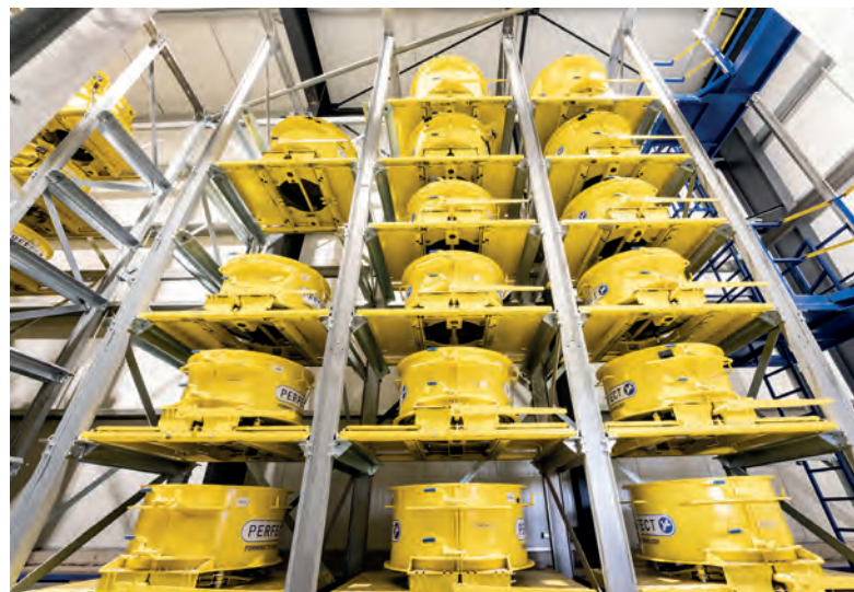
Эффективный способ выдержки изделий при производстве по технологии твердения в опалубке в сочетании с использованием энергии затвердевшего бетона
