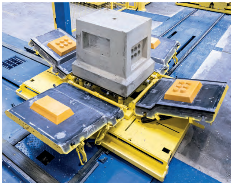
Прецизионные функциональные литейные формы для высококачественных бетонных элементов
