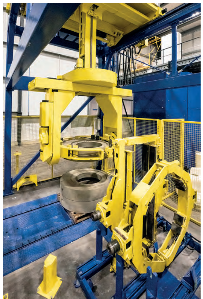
Автоматический манипулятор осторожно извлекает изделия из форм
